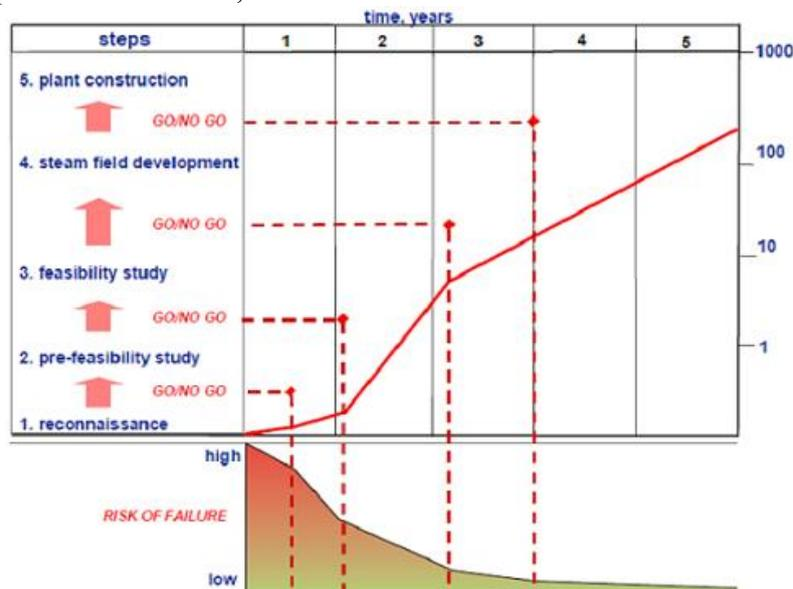
Fig. 7 : Coûts cumulés pour le développement d'une unité géothermique de 100 MW (en milliers de \$ US) et risques correspondants. On voit que les risques très élevés au début (forages d'exploration) vont décroissants avec le développement du gisement.
