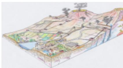
Fig.12 : Bloc diagramme schématisant le projet « Géothermal Village » combinant production d'électricité (centrale ORC sur zone fumerollienne), d'eau souterraine pour irrigation par pompage, et usage de l'énergie et du fluide à l'aval (séchage, serriculture, thermalisme...), sur le site de Barrier, rive sud du lac Turkana (in dossier GDC/Electerre proposé à EuropAid). Dessin Michel Villey.
