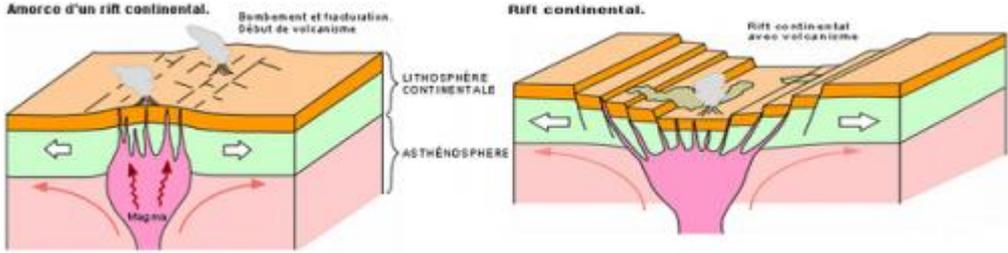
Fig. 3 et 4 : Dans un premier stade (25 Ma), on observe un bombement de la lithosphère, avec remontée du manteau chaud et production de magma sur les plateaux ; ceux-ci sont ensuite découpés par des failles normales délimitant la vallée du rift avec développement d'un volcanisme actuel dans son axe.
